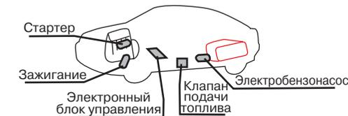
Блокировка должна препятствовать несанкционированному запуску двигателя и его работе в режиме ОХРАНА.
