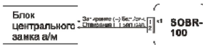
Схема подключения дополнительных электроприводов замков дверей к SOBR-100 C
