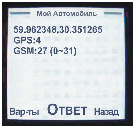
Команда помогает определить качество связи GSM и текущее состояние приемника GPS по количеству “видимых” спутников. Эта команда может использоваться при установке модуля, косвенно показывая правильность установки антенны GSM/GPS.
