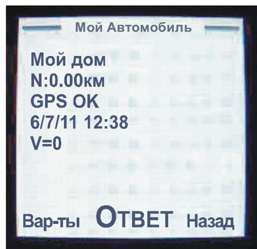
**Внимание.** При установке зоны контроля убедитесь, что во втором сообщении с местоположением автомобиля, данные о качестве сигнала GPS соответствуют его готовности (GPS OK) и название указанного объекта соответствует реальному положению автомобиля.
