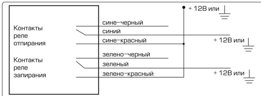
Схема подключения к двухпроводным приводам системы запираания
