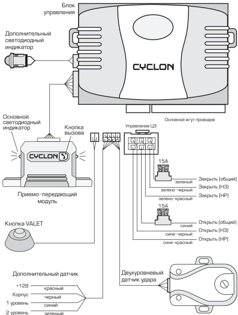
**10.10.2 Схема подключения сигнализации №2**
