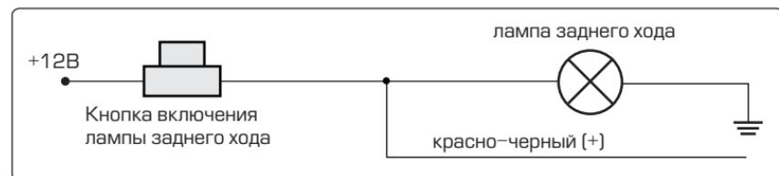
Данный провод необходимо подключить к штатному проводу автомобиля, на который подается питание +12В от концевого выключателя лампы заднего хода. При появлении +12В на красно-черном проводе сигнализация начинает подавать предупредительные сигналы в виде звуков сирены и мигания габаритных огней (либо поворотных огней – в зависимости от места подключения двух белых проводов сигнализации).
