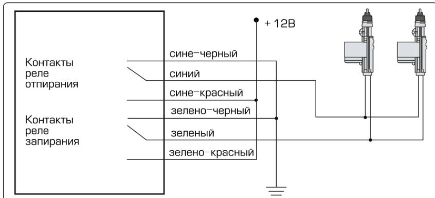
Схема подключения к пневматической системе запирания
