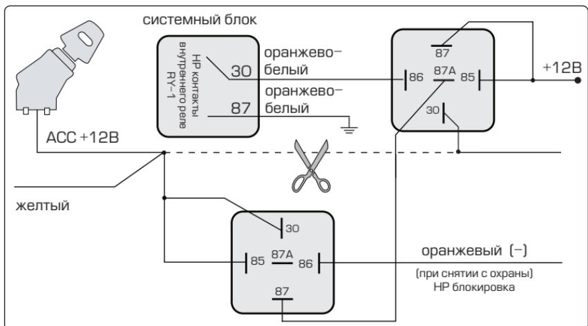
Схема подключения к соленоиду замка багажника с отрицательной полярностью
