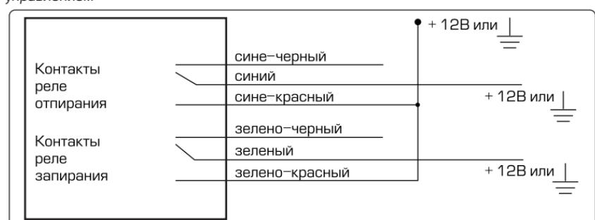
Схема подключения к двухпроводным приводам системы запирания
