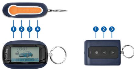
4-х кнопочный брелок с обратной связью и жидкокристаллическим (ЖК) дисплеем
