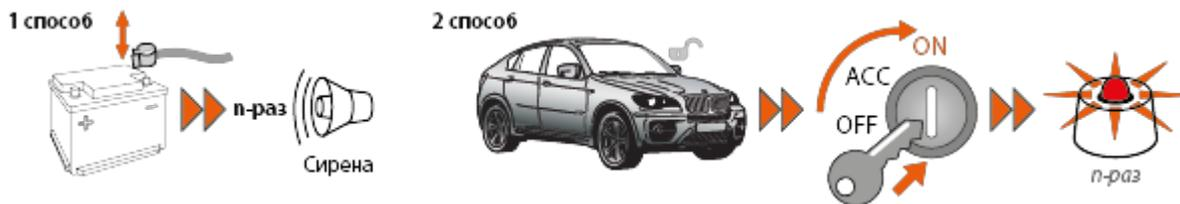
Проверить количество прописанных брелоков в систему можно, сняв и одев обратно клемму аккумулятора, при этом система количеством звуков сирены известит, сколько прописано брелоков. Также проверить количество брелоков можно по количеству оранжевых вспышек индикатора состояния при каждом включении зажигания при выключенной охране. Проверяйте периодически количество прописанных брелоков для полной уверенности в противоугонной стойкости системы.
