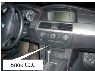
Рис. 2. Положение блока CCC в а/м BMW 3, 5 и 6 серий
