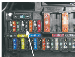
Рис. 7. Расположение предохранителя питания системы I-Drive
