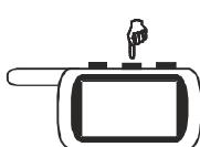
При работающем двигателе нажмите кнопку 2 брелка. Прозвучит мелодичный сигнал брелка. На дисплее брелка отобразятся иконка и одна из иконок, соответствующая продолжительности работы двигателя **r10, r20, r30, r99** (программируемой функции 2.2). Светодиодный индикатор загорится постоянно. Габаритные огни будут вспыхивать или останутся погашенными в зависимости от состояния программируемой функции 1.7
