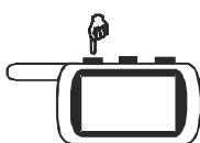
Нажмите кнопку 1 брелка. Система отреагирует 1 вспышкой габаритов. Прозвучат сначала 2 коротких, затем длительный звуковой сигнал брелка. После приглушенного звукового сигнала брелка на его дисплее высветится постоянно иконка **AUTO IMMO**, показывая активизацию автоматического включения режима охраны. Выключение режима иммобилизатора сопровождается исчезновением иконки **AUTO IMMO**.
