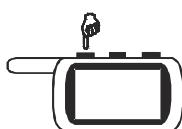
Нажмите кнопку 1 брелка. Система отреагирует 1 вспышкой габаритов. Прозвучат сначала 2 коротких, затем длительный звуковой сигнал брелка. После приглушенного звукового сигнала брелка на его дисплее постоянно высветится иконка **VALET**, показывая активизацию режима сервисного обслуживания. Светодиодный индикатор загорится постоянно. Выключение режима сервисного обслуживания сопровождается исчезновением иконки **VALET** и погасанием светодиодного индикатора.
