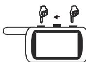
Включение / выключение канала №1 (желто-черный провод) осуществляется последовательным нажатием кнопок 3 и 1 брелка. Нажатие кнопки 3 должно быть длительным, нажатие кнопки 1 - коротким. Последуют 3 вспышки габаритов и 3 звуковых сигнала брелка.
