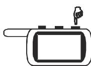
Нажмите и удерживайте кнопку 3 брелка в нажатом состоянии до появления сначала длительного, затем короткого звуковых сигналов брелка. После отпускания кнопки на индикаторе брелка начнет вспыхивать одна из иконок нижнего ряда. Короткими нажатиями кнопки 3 брелка установите курсор на иконку **AUTO ARM**.
