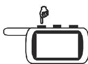
Нажмите кнопку 1 брелка. Система отреагирует 1 вспышкой габаритов. Прозвучат сначала 2 коротких, затем длительный звуковой сигнал брелка. После приглушенного звукового сигнала брелка на его дисплее высветится постоянно иконка **AUTO ARM**, показывая активизацию автоматического включения режима охраны. Выключение функции автоматического включения режима охраны сопровождается исчезновением иконки **AUTO ARM**.
