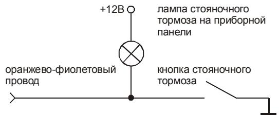
На автомобилях с автоматической КПП подключите этот провод к кнопке педали тормоза, замыкающейся на +12В при нажатии педали тормоза.
