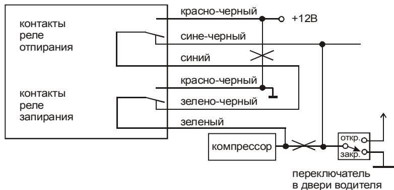
**Схема подключения активатора двери водителя
