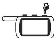
Нажмите и удерживайте кнопку 3 брелка в нажатом состоянии до появления сначала длительного, затем короткого звуковых сигналов брелка. После отпускания кнопки на индикаторе брелка начнет вспыхивать одна из иконок нижнего ряда. Короткими нажатиями кнопки 3 брелка установите курсор на иконку **VALET**.
