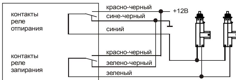
**Схема подключения к пневматической системе запирания**
